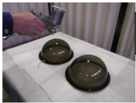
Oガス会社 監視カメラカバー親水試験
