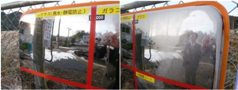
JR M支社 軌道敷内カーブミラー防曇試験
